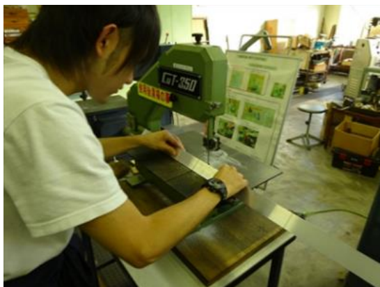
材料の切断(コンターマシン)
